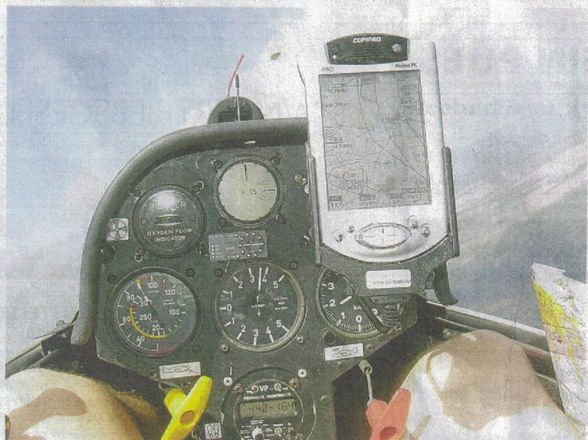
Ein Segelflug-Cockpit kommt heute ohne hochmoderne Instrumente nicht aus. Dazu gehören das elektrische Variometer und der GPS-gesteuerte Logger (Flugwegschreiber).
